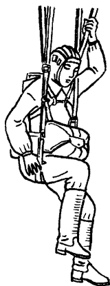
Рис.3 Заправка главной лямки подвесной системы.
