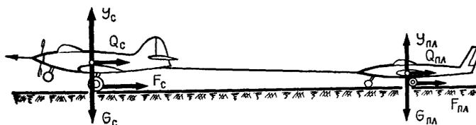
**Рис. 5 Взлет аэропоезда**
